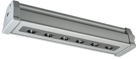
**Hohe Schutzart und hohe Schlagfestigkeit.** Gehäuse aus Stahlblech mit Kappen aus Aluminium-Druckguss. High-Power-LEDs mit Lichtlenkung durch spezielle Linsen für asymmetrisch strahlende Lichtverteilung mit extrem großen Leuchtenabständen von > 100 m bei Höhen von 2,5 bis 20 m, z. B. in Tunnel oder Hallen (Beleuchtung von Rettungswegen mit 1 lx). Extrem beständig gegen mechanische und chemische Beanspruchung.
